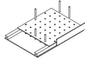
Aligner les deux panneaux perforés avec au moins 5 tourillons entre les deux planches pour tenir un bon positionnement entre le mur et la façade. Pour assurer la perpendicularité des tasseaux, faire glisser une des étagères tout au long du bord extérieur et vérifier qu'il y a un espacement de 1 cm.
