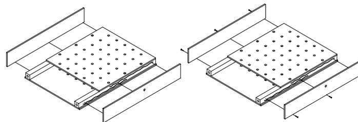
Coller le côté droit est à l'assemblage et fixer avec deux serre joints. Faire la même opération avec le côté gauche est.
