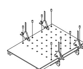
Enlever les serre joints et verser de la colle sur une face des tasseaux, positionner ensuite le panneau perforé, et puis verser de la colle dans le trou pour insérer le petit tourillon de 3 cm à l'aide d'un maillet.
