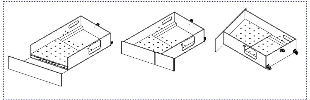
① Coller les deux pièces, et laisser sécher au moins 1 heure avec deux serre joints.
