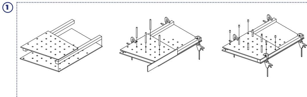
Suivre la même procédure pour aligner les panneaux perforés avec les tourillons, et serre joints. Cette fois avec les tasseaux coupés avec un angle de 15°
