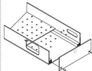
Une fois les côtés vissées, garder l'assemblage à plat. Positionner la pièce de base ouest et vérifier l'alignement des bords, l'alignement entre les perforations du tasseau en bas et les trous de la planche.
