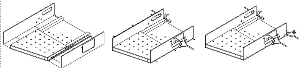
Une fois la colle sèche, enlever tous les serre joints et déposer "les panneaux perforés et tasseaux ouest" à plat délicatement sur une surface propre, de préférence sur une nappe ou un drap.
